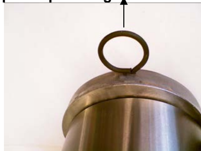
Fig. 3: Variant 2 – verwijder de pin na plaatsing van de riem
