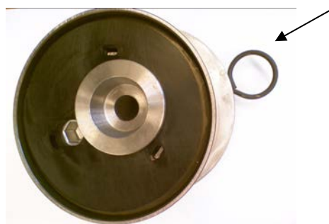
Fig. 2 Poelie uitvoering zonder pin
